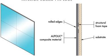
**INTERIOR ROLLED PIN EDGE**
